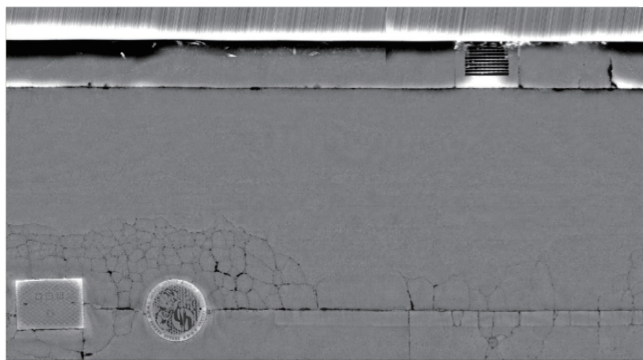
路面下空洞(Cモード平面画像)
