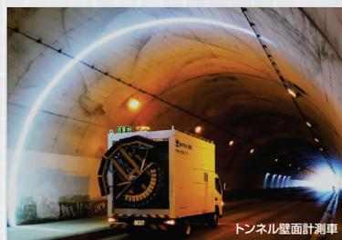
トンネル壁面計測車
